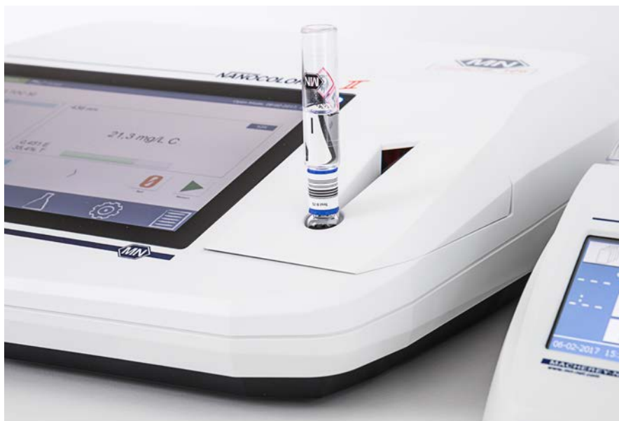
Quantitative Detektion des gebildeten CO 2 mittels Indikator (Reaktionsgrundlage analog zu DIN EN 1484)
